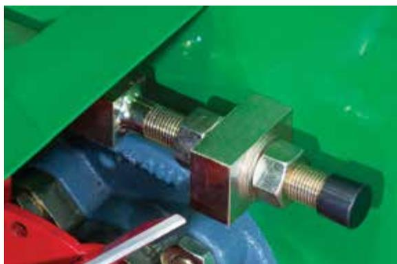
Регулировка цилиндра к нижнему ножу с помощью одного ключа
