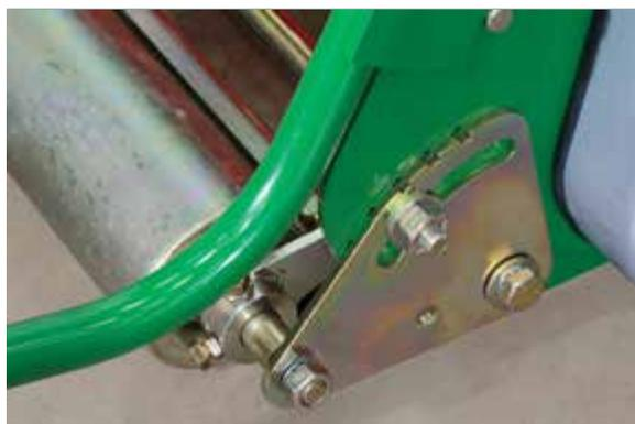
Точный контроль высоты среза, который легко регулируется на обеих сторонах с помощью одного гаечного ключа
