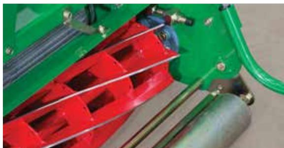
Срезающий цилиндр большого диаметра для высокой производительности
